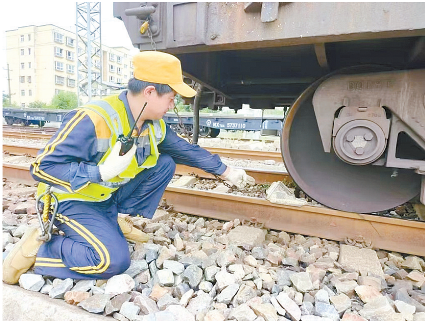
铁路职工俯身紧固列车底部安全链条。
